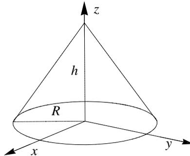
Bestimmen Sie das Trägheitsmoment des abgebildeten Kreiskegels  $B$  mit Höhe  $h$  und Grundkreisradius  $R$  bezüglich der  $z$ -Achse. D.h. berechnen Sie
